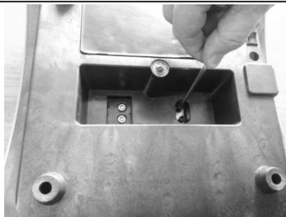
Прикрутить двумя болтами датчик к грузовой платформе Г-образным шестигранным ключом.
